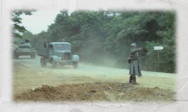
Camion standardisé de 2,5 tonnes conçu pour les forces armées allemandes avant et pendant la Seconde Guerre mondiale. Version produite de 1937 à 1940, un camion à trois essieux avec une capacité de charge utile de 2,5 tonnes. Malgré une réputation de durabilité et de fiabilité, le Einheitsdiesel avait une capacité de charge utile relativement faible par rapport à son poids à vide d'environ cinq tonnes.
