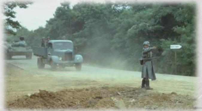
Camion standardisé de 2,5 tonnes conçu pour les forces armées allemandes avant et pendant la Seconde Guerre mondiale. Version produite de 1937 à 1940, un camion à trois essieux avec une capacité de charge utile de 2,5 tonnes. Malgré une réputation de durabilité et de fiabilité, le Einheitsdiesel avait une capacité de charge utile relativement faible par rapport à son poids à vide d'environ cinq tonnes.
