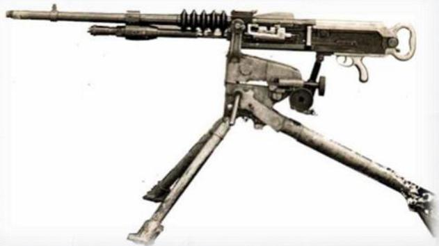
La mitrailleuse Hotchkiss modèle 1914 en calibre 8 mm Lebel était la principale arme automatique de l'armée française pendant les dernières années de la Première Guerre mondiale. C'est une arme robuste et précise d'un fonctionnement sûr et régulier même dans les conditions les plus difficiles de combat.
