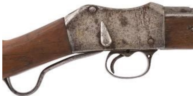
Le système Martini-Henry (avec un levier sous la poignée)
