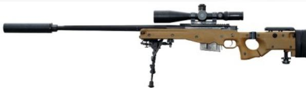
L'Accuracy International AWM est un fusil de précision à verrou conçu pour les cartouches de fusil magnum. Maintenant considéré comme le fusil de précision principal pour tous les tireurs d'élite britanniques entraînés. Il est équipé d'une lunette de visée 25x, d'un silencieux, d'une crosse pliable, d'un chargeur Lapua Magnum .338 à cinq coups et a une portée effective supérieure à 1 100 m.
