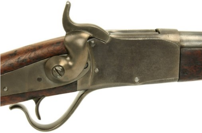
Le système Peabody (le pontet sert de levier)
