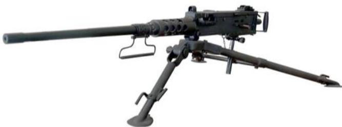
La Browning M2 est une mitrailleuse lourde chamberée en 12,7 × 99 mm, une munition également connue sous le nom de .50 BMG.
