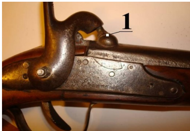
En 1, c'est l'emplacement de la capsule que le marteau du chien vient frapper
